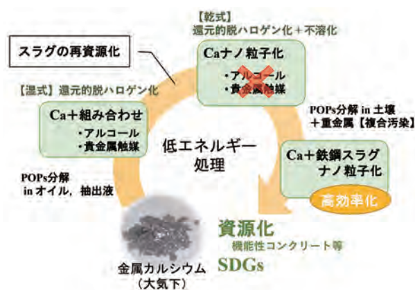
図1 金属カルシウム系薬剤の資源循環型浄化プロセス
