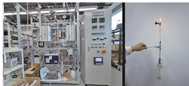
写真1 小型ベンチプラントと生成LPGの燃焼試験の様子
