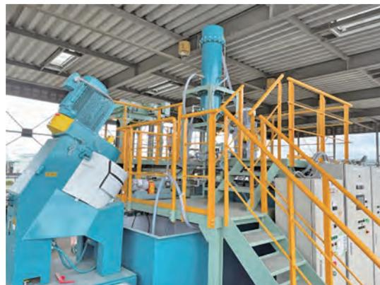
写真1 燃焼灰改質パイロット装置
