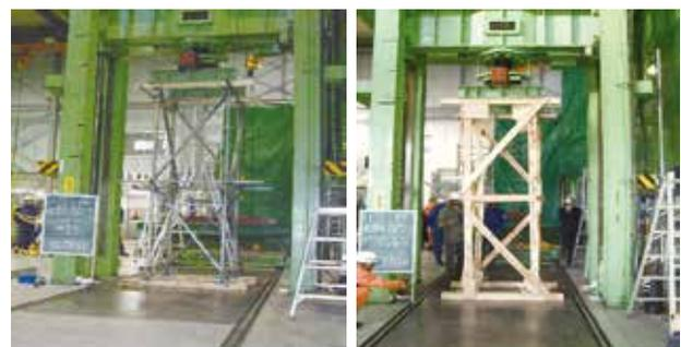
図4 梁の強度検証とショアリングの様子
