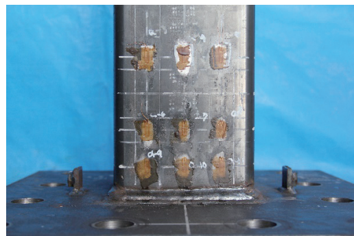
写真4 n=0.15 実験後の柱脚の様子
