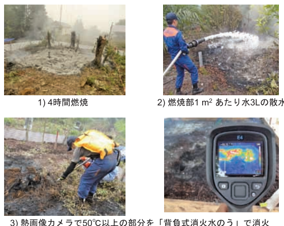
図10 泥炭火災の消火手順
