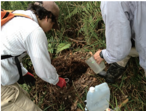
写真10 泥炭土壌の透水試験
