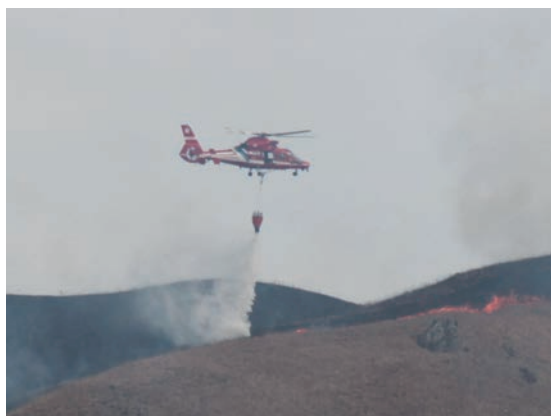
写真3 泡消火剤の空中散布による消火
