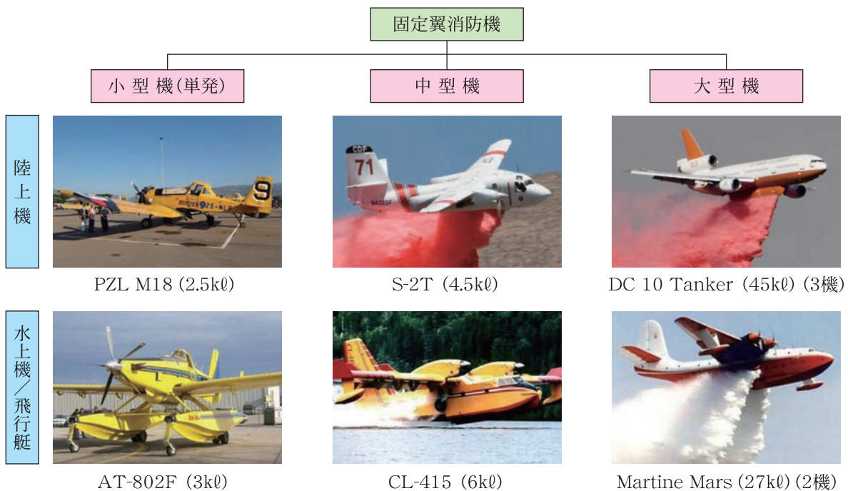
図6 固定翼消防機の種類と例
