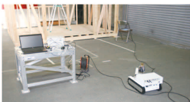
(b)制御用PCと計測用ロボット 図5 火災現場監視カメラ
