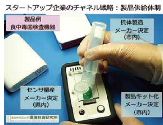
図-2. 量産型スマートセンサの試作器
