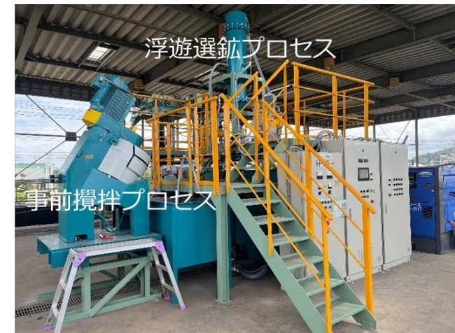
写真3 開発した燃焼灰改質パイロット装置
