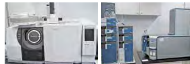
写真1 網羅分析用のGC-MS(左)とLC-QTOFMS(右)
