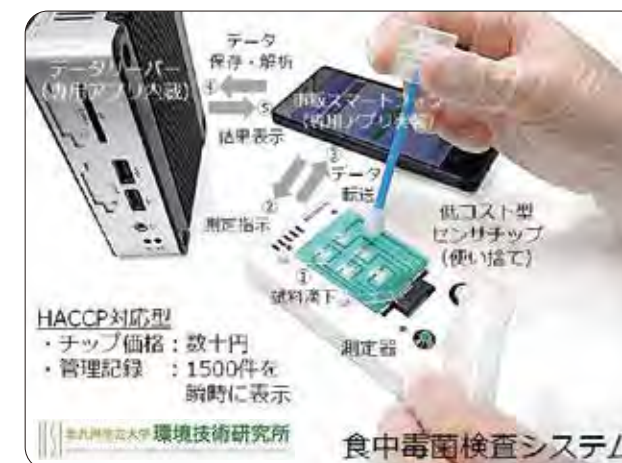
図-2 実証中の食中毒菌センサの外観と性能
