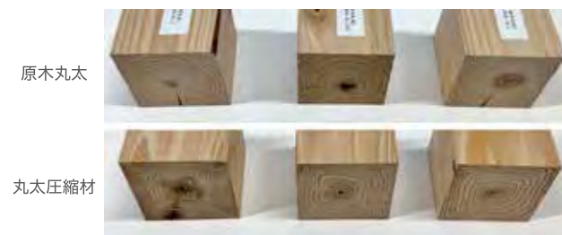
乾燥後も割れや変形が生じにくい圧縮木材 (下)
