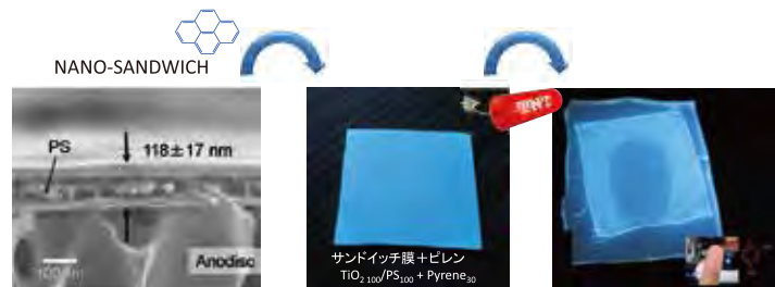
爆薬粉末を付着した指を蛍光基板（エキシマー蛍光導入）に接触 爆薬応答の顕著な違いが素早く観察
