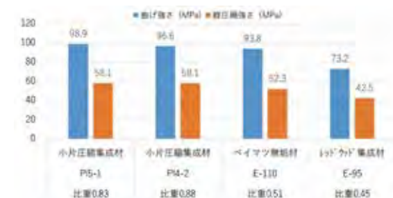
杉圧縮木材と流通材の強度比較
