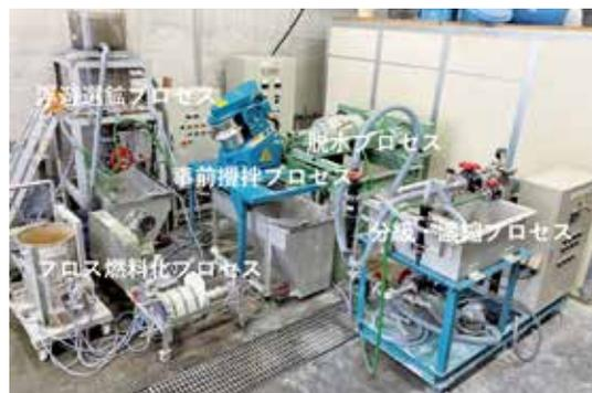
写真1 発電由来燃焼灰改質ラボ装置(28.8ton/y)
