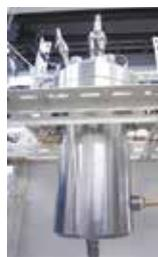
図1 内部凝縮型反応器(ICR)試作器の外観
