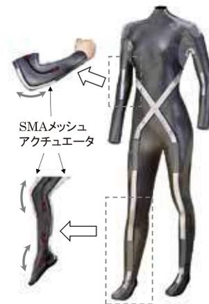
図3 布状形状記憶合金アクチュエータ素子を用いたウェアラブルアシストスーツ
