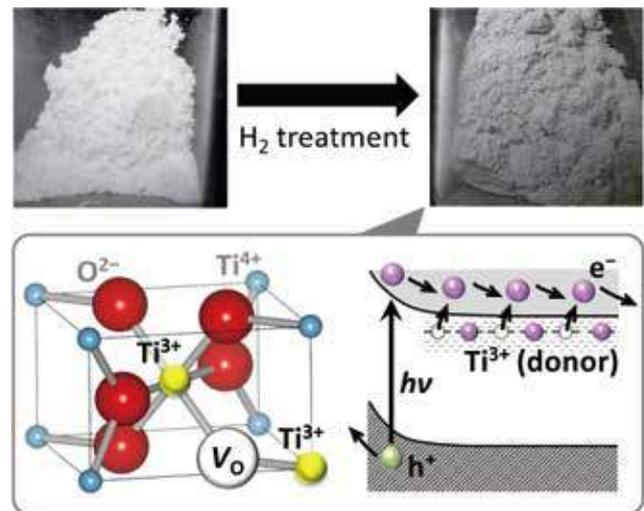
図2 過剰な電子を含むルチル型 $TiO_2$ 光触媒の電荷分離機構
