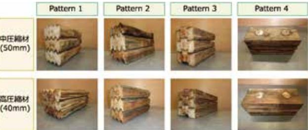
図5 金属治具による木ブロック製造実験 (圧縮強度が高まっており、木ブロックなどの用途も考えられる)
