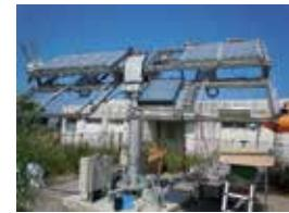
図2 集光型太陽電池と水分解電気化学セルは直接接続している。写真是実際の測定風景。集光型太陽電池は追尾装置の右下中付近に3つ、電気化学セルは机の上に並べられている。
