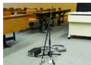
図2 EA法による吸音特性の測定の様子
