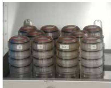
写真4 気中(汚染)物質(気体や粒子状物質)を連続的に採取する装置の採取部分(ろ紙をセットしたフィルターホルダー(10本)を自動的に切り替えて大気中(汚染)物質を採取します。)
