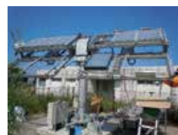
図2 集光型太陽電池と水分解電気化学セルは直接接続している。写真は実際の測定風景。集光型太陽電池は追尾装置の右下中付近に3つ、電気化学セルは机の上に並べられている。
