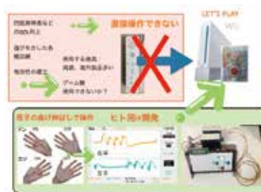
図2 EMG(筋電位)を用いた市販ゲーム機のリハ応用例
