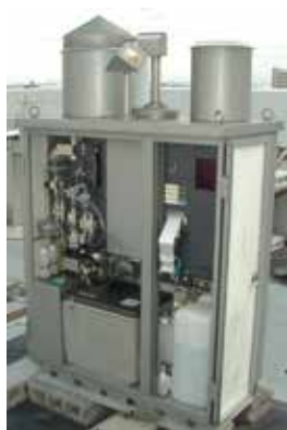
写真2 雨を降水量0.5mmごとに自動分析する装置
