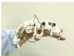
図2 関節可動域訓練用ロボット
