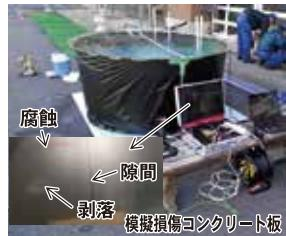
写真-3 水中濁度とコンクリートの損傷等識別精度の実験状況
