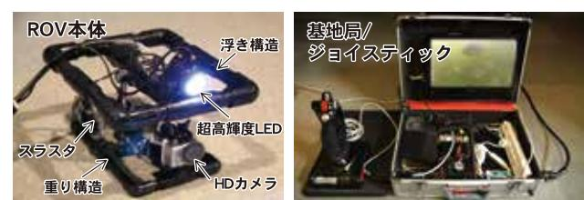
写真-1 “水中Hi-ROV”的全体システム
