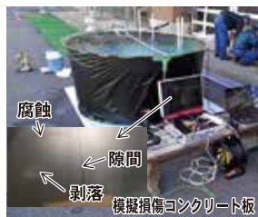
写真-3 水中濁度とコンクリートの損傷等識別精度の実験状況
