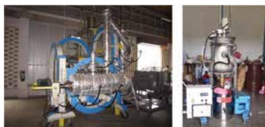
HiBD製造用反応設備 吸着剤処理装置 図3 HiBD製造用パイロットプラント チュラロンコン大学サラブリキャンパス(タイ)
