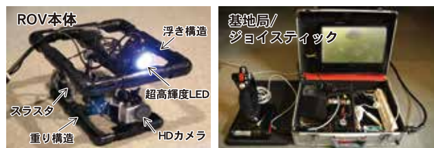
写真-1 “水中Hi-ROV”の全体システム
