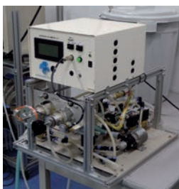
図2 ベルト駆動による渦巻きばね型SMA熱エンジン
