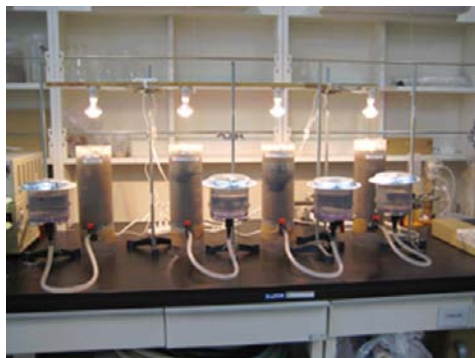
写真-2 蒸発移行抑制確認実験
