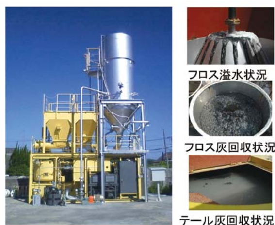
写真3 実機未燃カーボン除去装置
