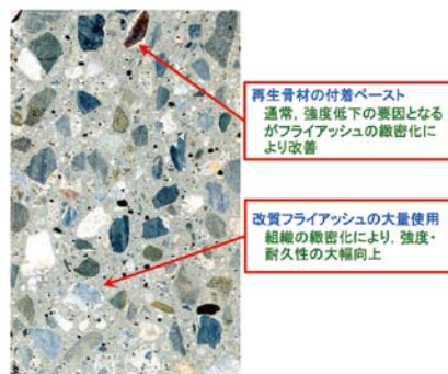
図7 フライアッシュを混合した再生骨材コンクリートの切断面
