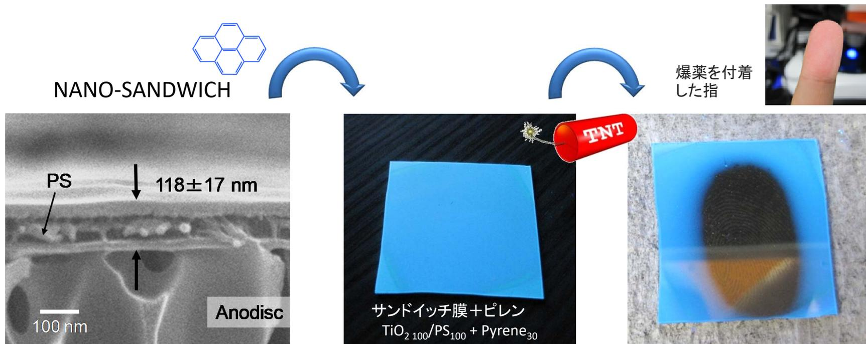
爆薬粉末を付着した指を蛍光基板(エキシマー蛍光導入)に接触
