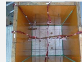
1m×1m×1m の柱モデル試験体による、温度、含水率、強度、細孔分布
