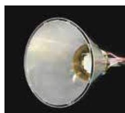
**【内容】**本発明は、投光器に本来付属しているリフレクターに放熱機能を持たせてLED光源裏面のヒートシンクからの放熱量を減らすとともに、光源部を均温化(局所高温部の消失)することで、ヒートシンクを小型・軽量化するものである。放熱機能付きリフレクター(放熱パネル)は、多層の放熱板、それらの間に設置した微細フィン、LED実装部から放熱パネル全体に熱輸送するヒートパイプから構成される。
