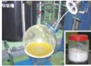
図2 150日間の実証試験後の蒸発晶析物 [1]
