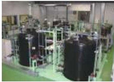
図1 海水リチウム回収プラント [1]
