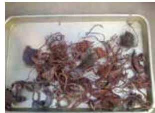
写真-3 焼却灰から回収された銅
