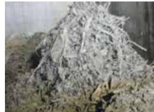
写真-1 焼却灰から回収された鉄
