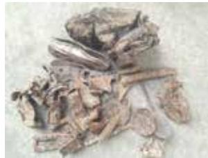
写真-2 焼却灰から回収されたステンレス
