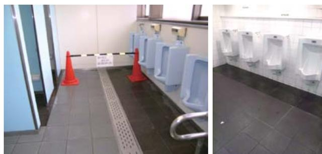
Fig. 2 光触媒タイルの公衆トイレへの施工例
