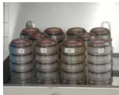
写真4 気中(汚染)物質(気体や粒子状物質)を連続的に採取する装置の採取部分(ろ紙をセットしたフィルターホルダー(10本)を自動的に切り替えて大気中(汚染)物質を採取します。)
