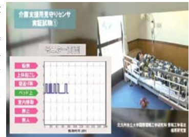
図2 介護施設での実証実験光景(カメラモニタによるセンサの状態推定の確認)
