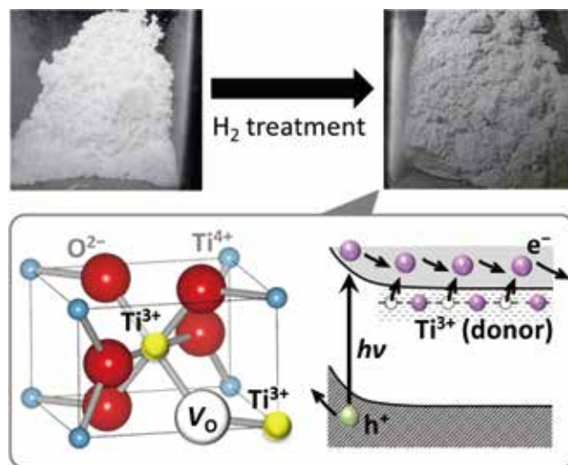
図2 過剰な電子を含むルチル型 TiO_2 光触媒の電荷分離機構
